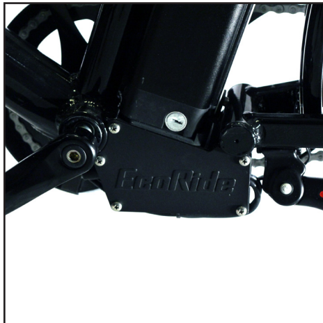
9 Styrbox-utrymme under batteriet
